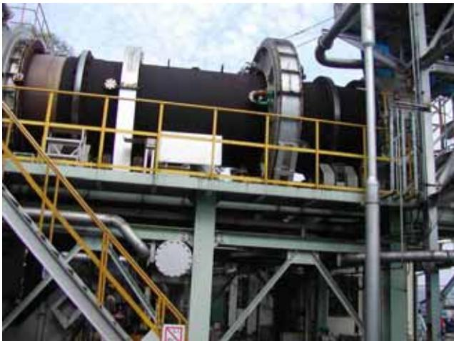
写真 3-1 装置写真 (ロータリーキルン炉)
