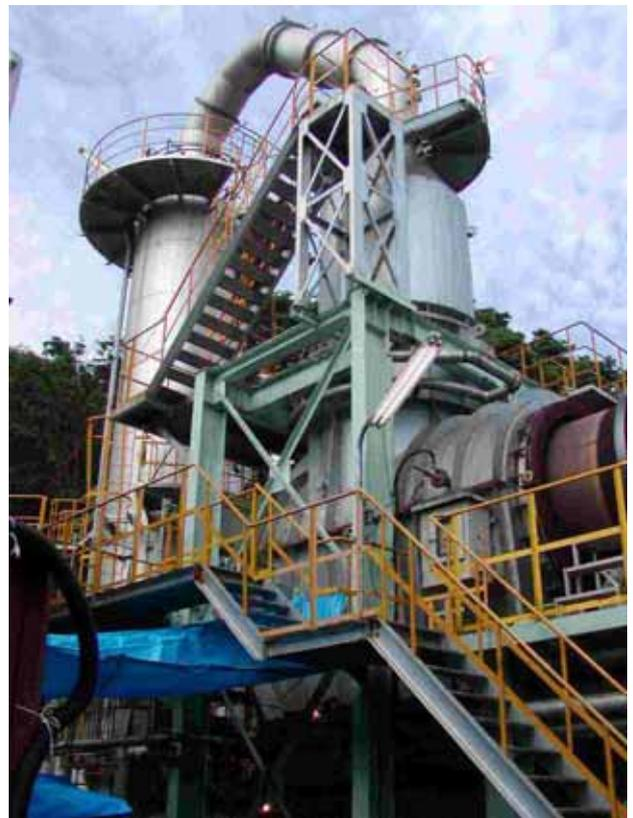
写真 3-2 装置写真 (二次燃焼炉、ガス冷却塔)
