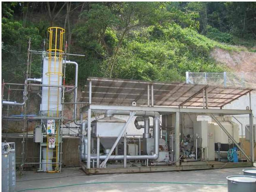
写真 2-2 装置写真（BF、排ガス処理設備）
