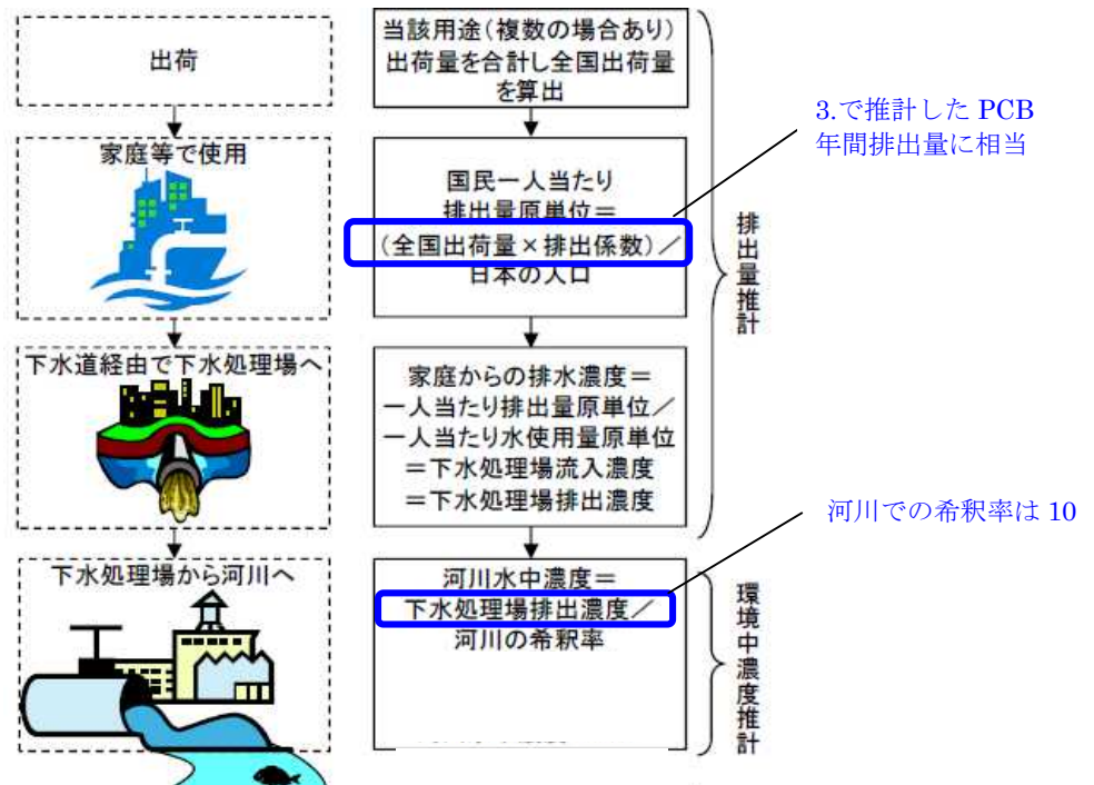
図表 5.6 化粧品由来の PCB に関する河川水中濃度の推計方法
