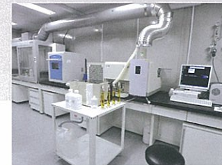
処理水の水質検査を行います。総ヒ素をICP発光分光分析装置で測定するなど、排出管理基準値内の水質であることを確認します。
