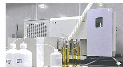
処理水の水質検査を行います。総ヒ素をICP発光分光分析装置で測定するなど、排出管理基準値内の水質であることを確認します。
