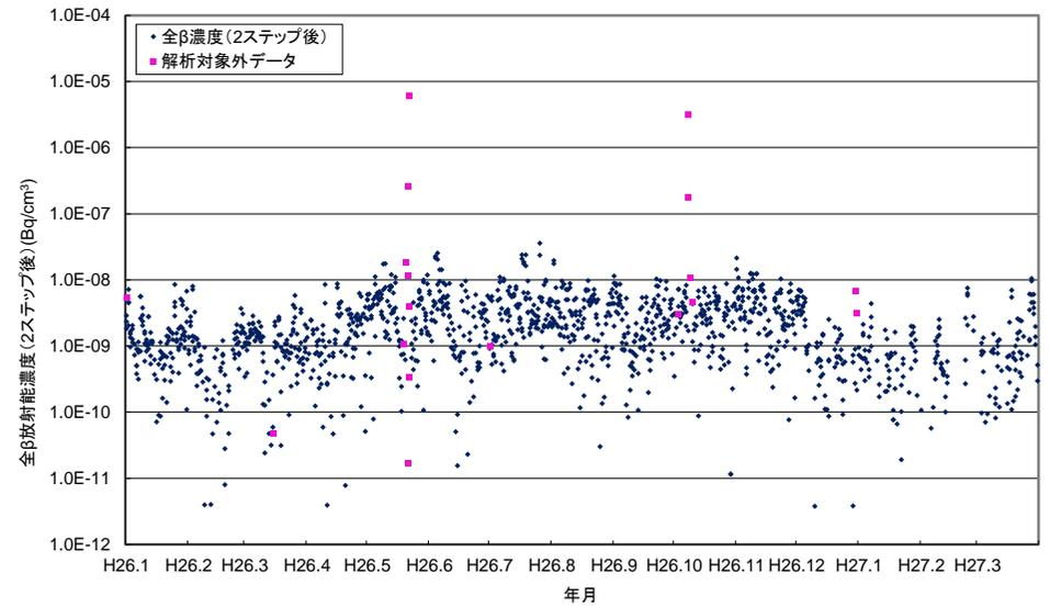
付図4-4 利尻測定所における大気浮遊じん的全β放射能濃度(2ステップ後)の経時変化
