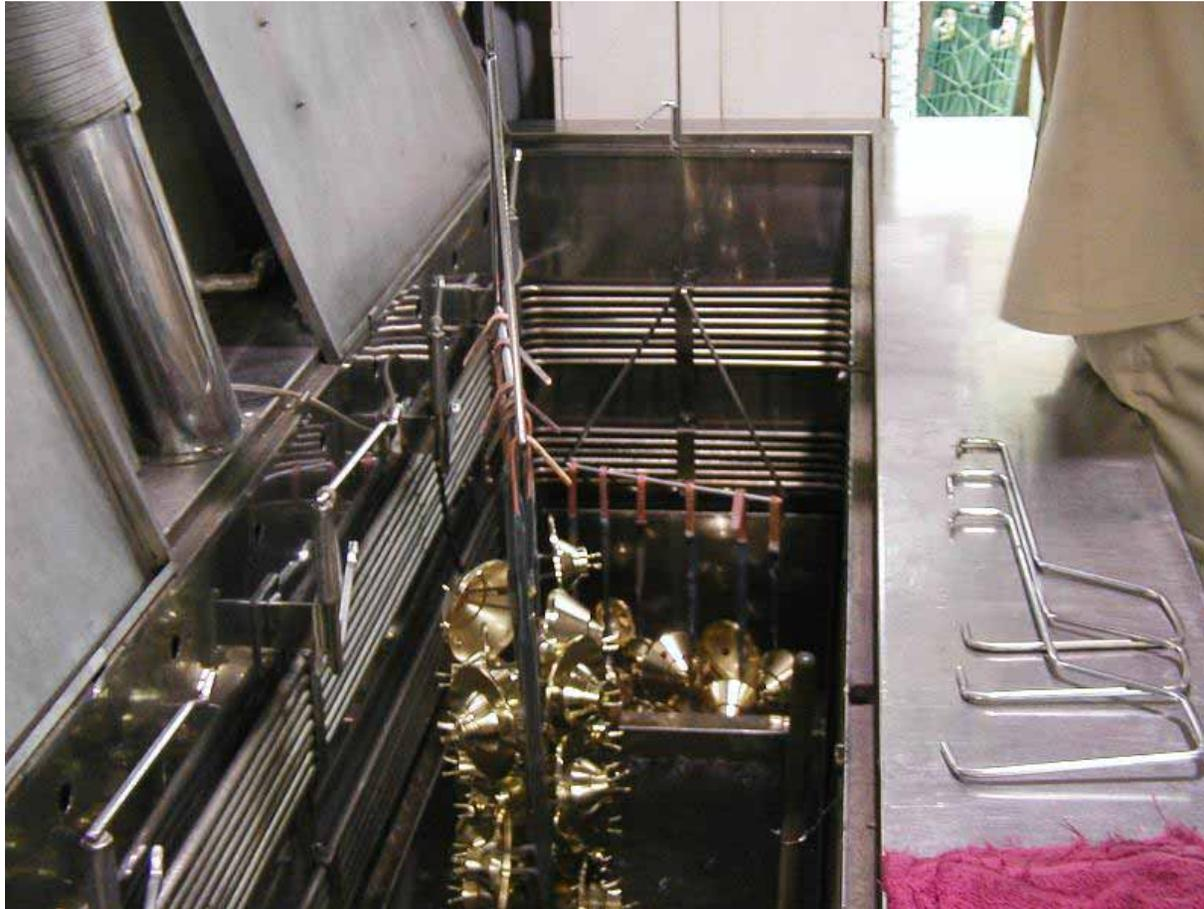
仕上げ洗浄 ( 開口  $500 \times 2700\text{mm}$  )
