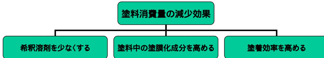
エアスプレイ塗装の場合  $180 \text{ (g/m}^2\text{)} = 25 \text{ (}\mu\text{)} \times 1.2\text{(SG)} \times \frac{10 + 5}{5 \times 0.5}$
