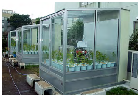
写真1 粒子暴露チャンバー (東京農工大学, 東京都府中市) 注: チャンバー内部の中央に、ブラックカーボン粒子発生装置が設置されている
