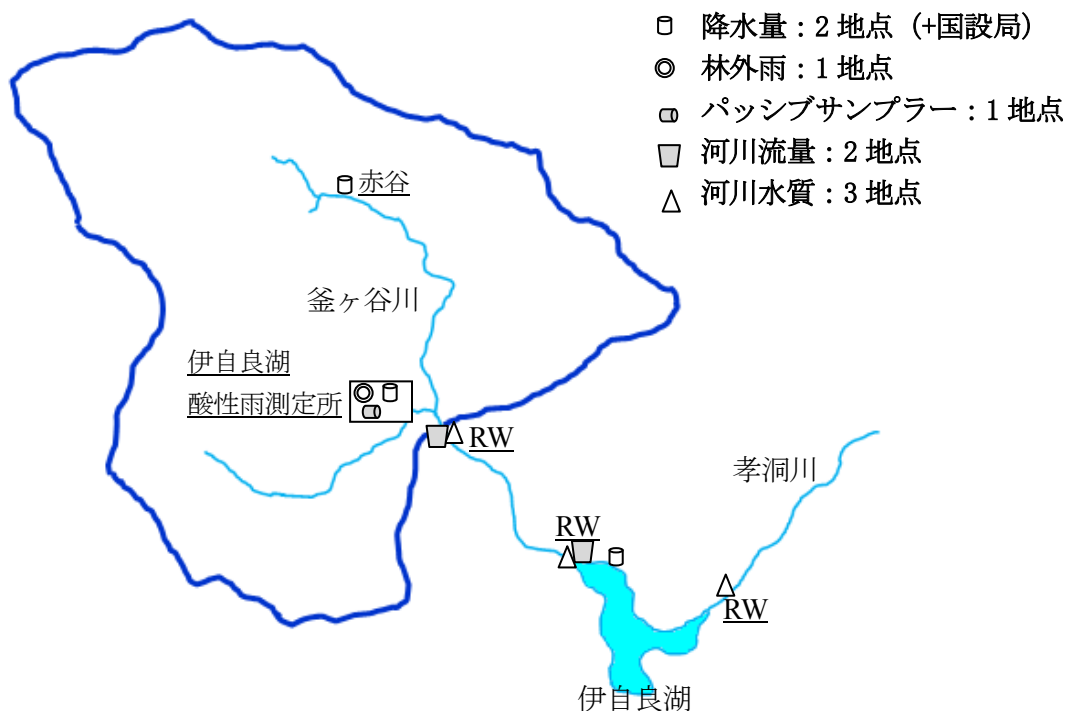
図5-1 伊自良湖集水域モニタリング装置配置図 注：太線内は、物質収支解析を行った釜ヶ谷川の集水域を示す。
