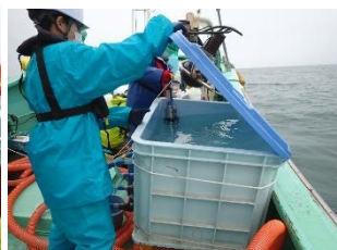
②大型容器への採水 ②塩分等の測定
