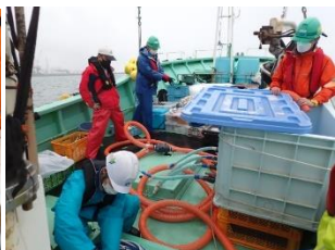
②大型容器への採水 ②塩分等の測定
