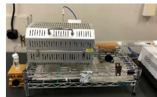
燃焼による I-129の分離精製
