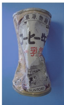
写真 2 コンクリート様の塊の中から発見された飲料用缶 (缶底記載の製造年月日:1993(平成 5)年 6 月 28 日)
