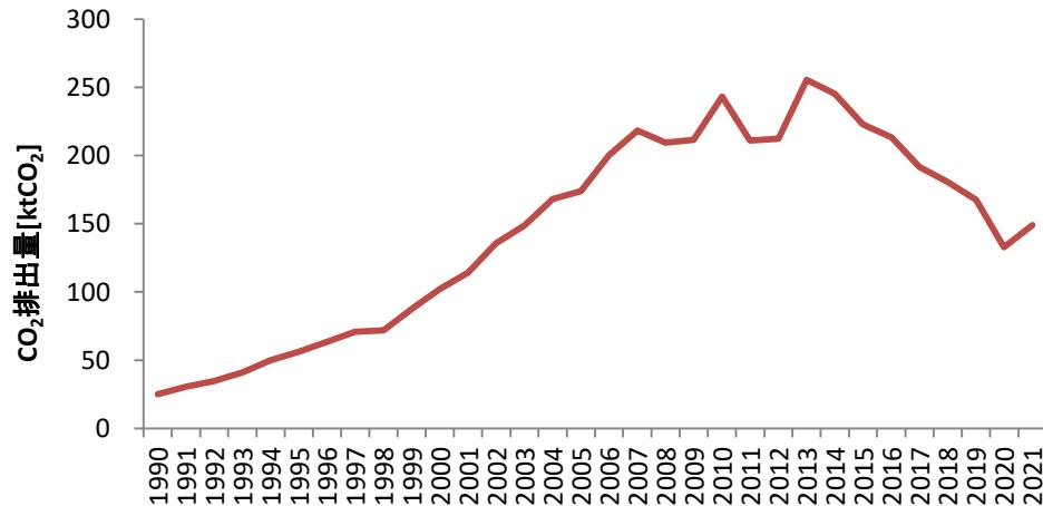
図 2 鋼鉄製造からの CO<sub>2</sub> 排出量（副生ガスのフレアリング起源）の推移
