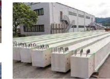
スラブ橋桁(中空床版橋)
