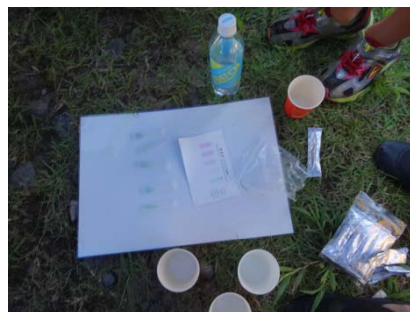
パックテストによる水質調査
