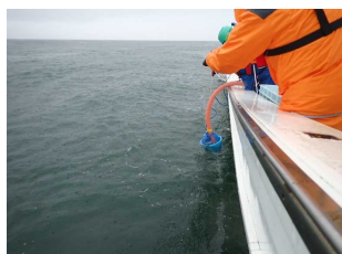
①ポンプの投下
