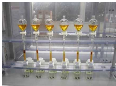
陰イオン交換樹脂によるPuの分離精製
