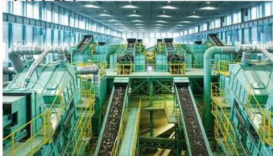
プラスチック資源循環法に基づき、複数の自治体とプラスチック資源のリサイクルを実施。写真はソーティングセンター
