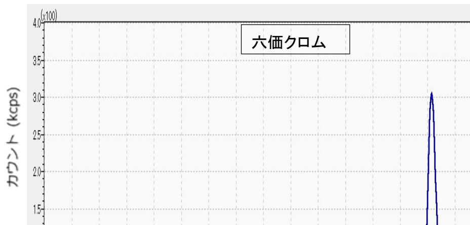
六価クロム標準溶液 (1 ng/mL) のクロマトグラム
