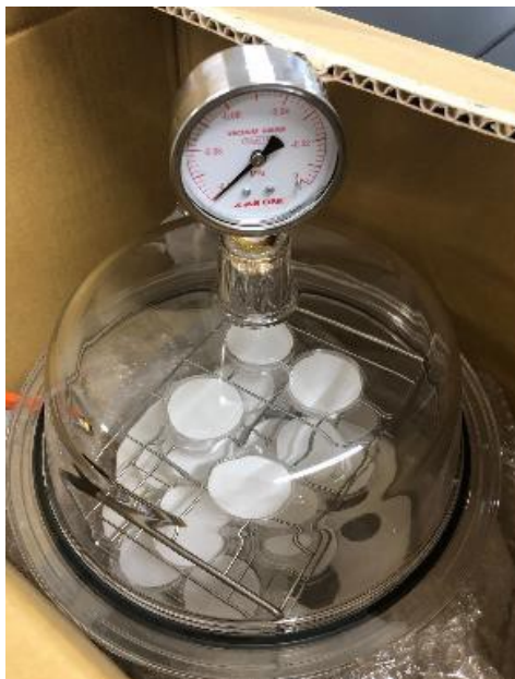
図6 真空デシケータ内でのフィルタ乾燥（例）
