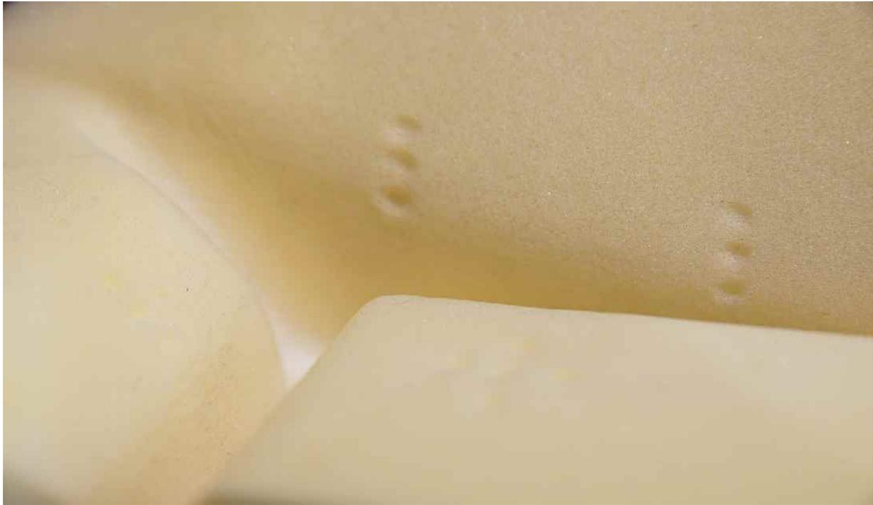
図 2-15 : 人工構造タンパク質-ウレタン複合材
