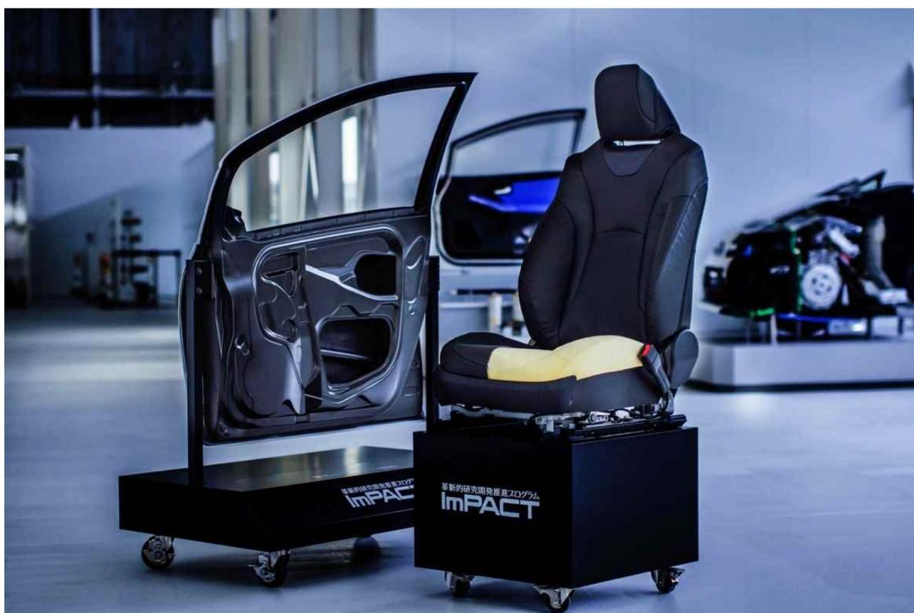
図8.1-13：人工構造タンパク質素材を使用した自動車ドアパネル及びシートの試作
