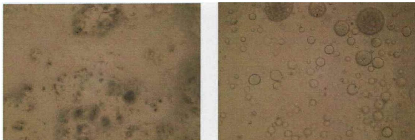
図 5.3-8 : 硫酸アルミニウム水溶液での塩析（左）と塩化ナトリウム水溶液での塩析（右）
