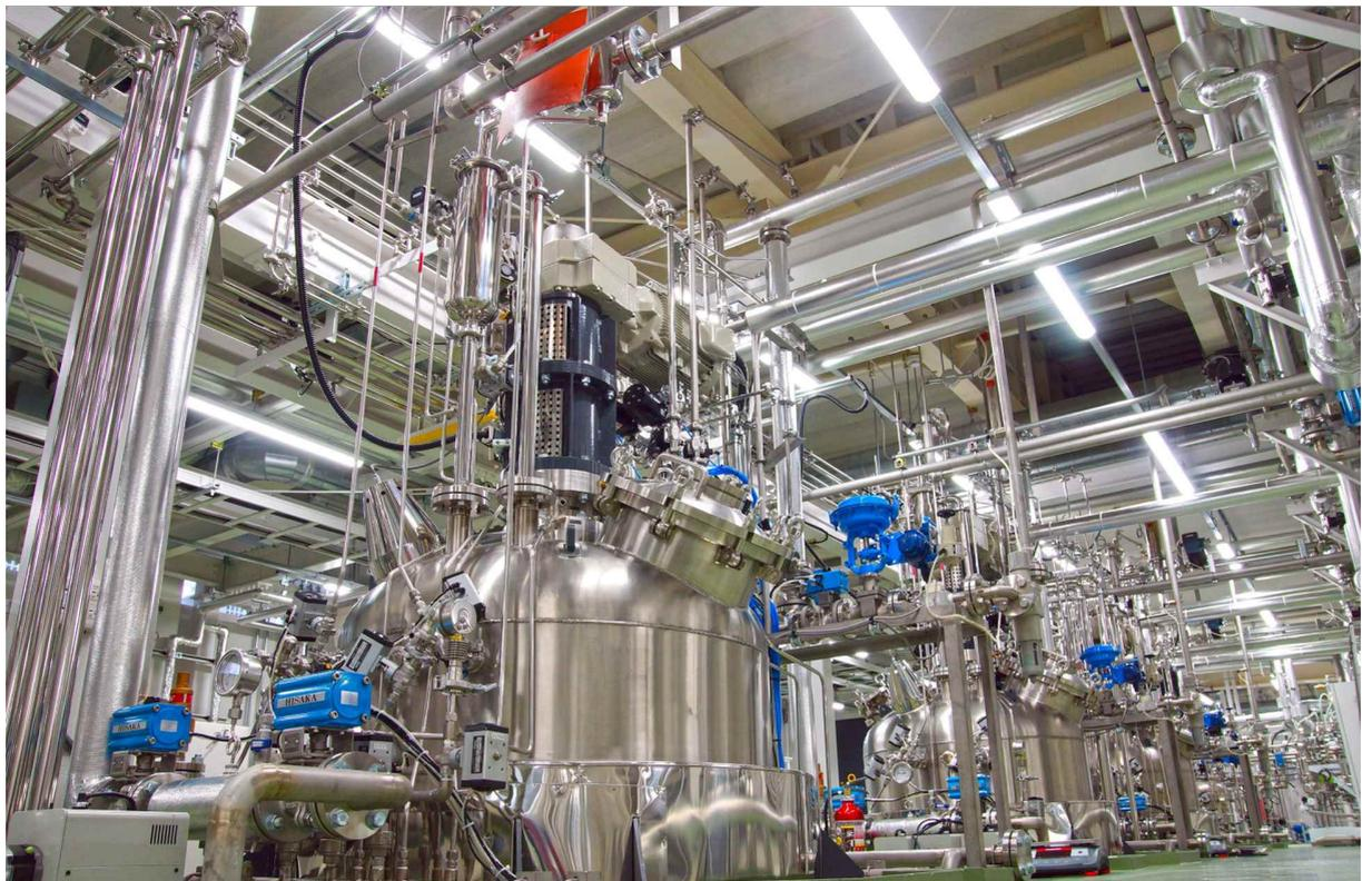
図 2-3 : 大規模培養槽
