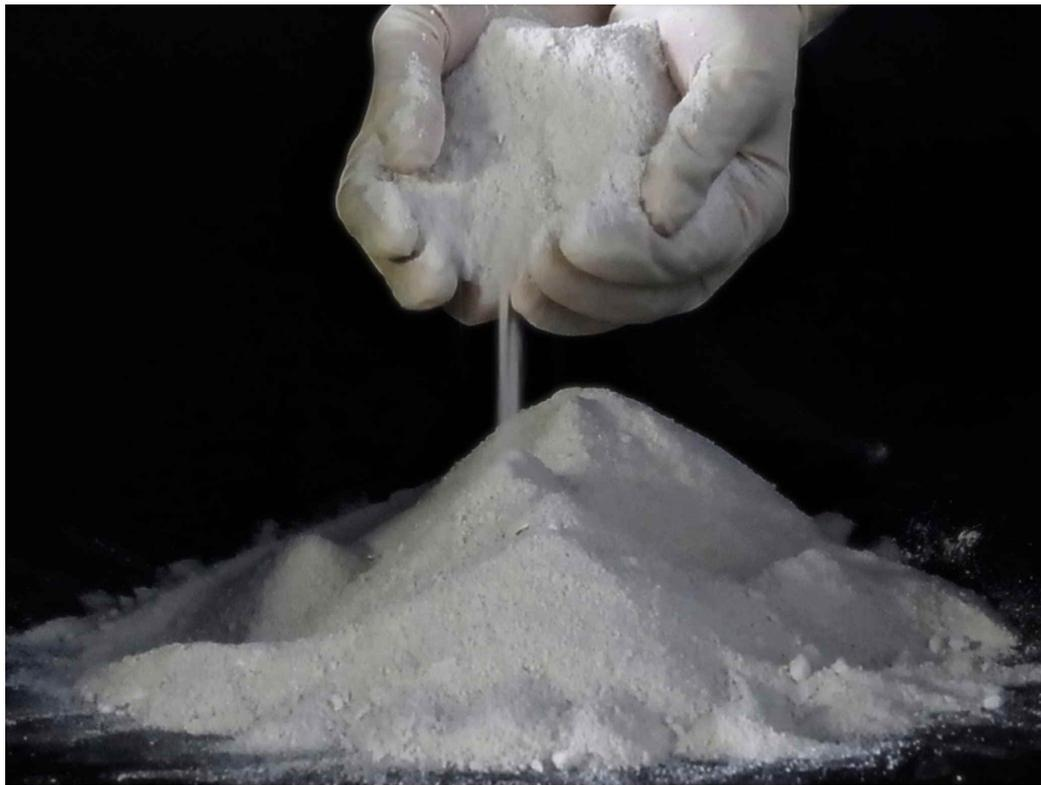
図 2-4：精製後に乾燥させた人工構造タンパク質粉末
