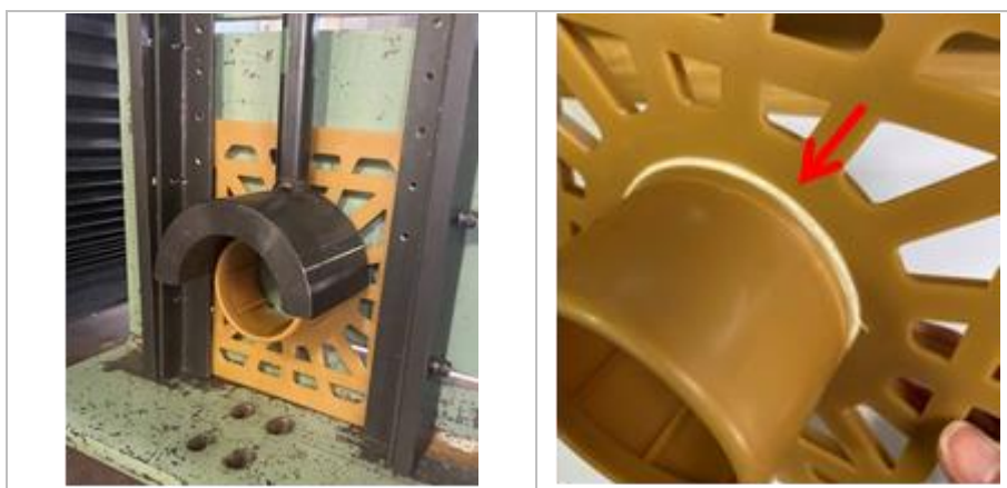
図 2-4-3-4 プラグ強度試験の様子（左）とプラグ根元のクラック（右）
