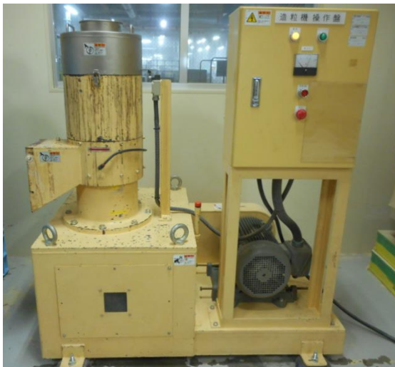
図 2-1-2-3 ディスクペレッター（左）とその処理概要（右）
