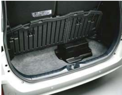
図 3.5.1.2 PP-GF 樹脂によるフロアボード写真
