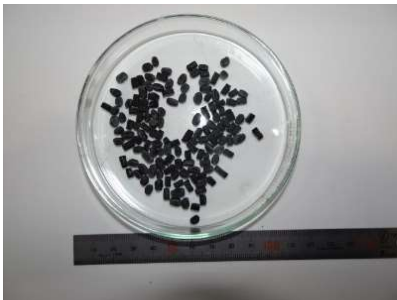
図 2.3.1.2 パルプ・バイオ PE 複合ボード リペレット外観
