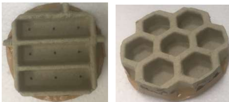
図 1.1.8.1.3 パルプモールド吸音材サンプル (左：直方体型、右：ハニカム型)
