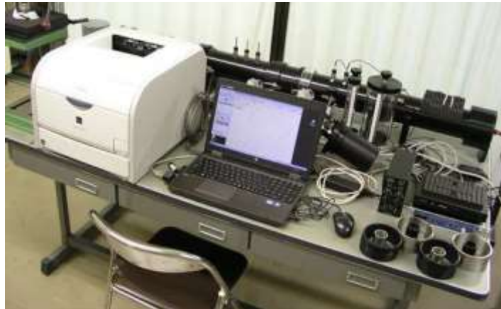
図 1.1.8.1.1 垂直入射吸音率測定装置 (WinZacMTX)
