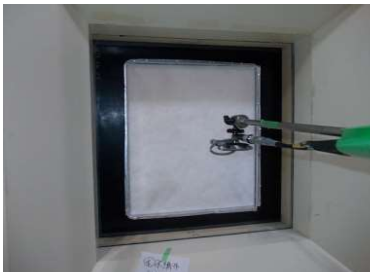
図 1. 1. 8. 7. 2 PET 不織布遮音性試験状況
