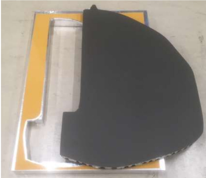
図 1.3.4.1 パルプ・バイオPE複合ボードにて作製したフロアボード部品
