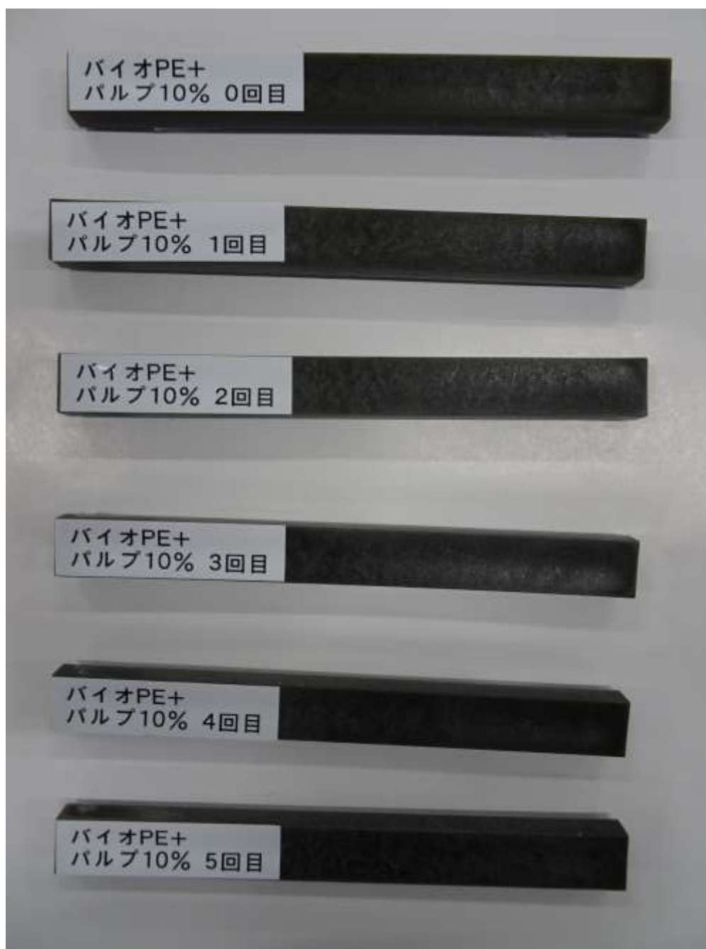
図 2.2.2.1 工程内リサイクル回数の増加による外観の変化(バイオPE-パルプ 10)
