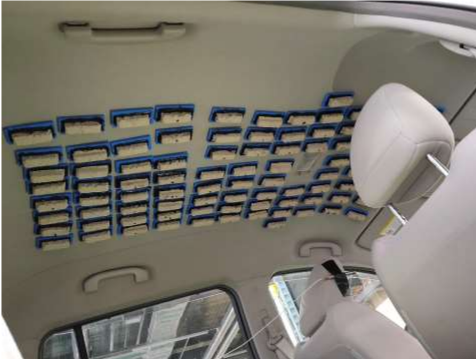
図 1.1.8.9.1 パルプモールド吸音材実車装着状態
