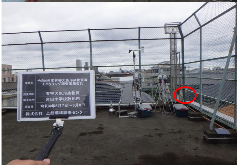
ポンプ等を入れてるボックス
