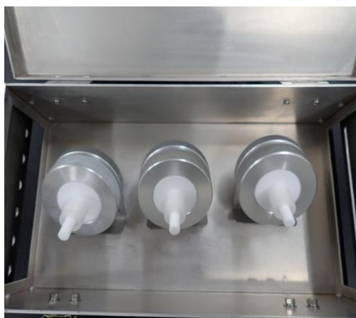
採気箱内状況（トラベルブランク）
