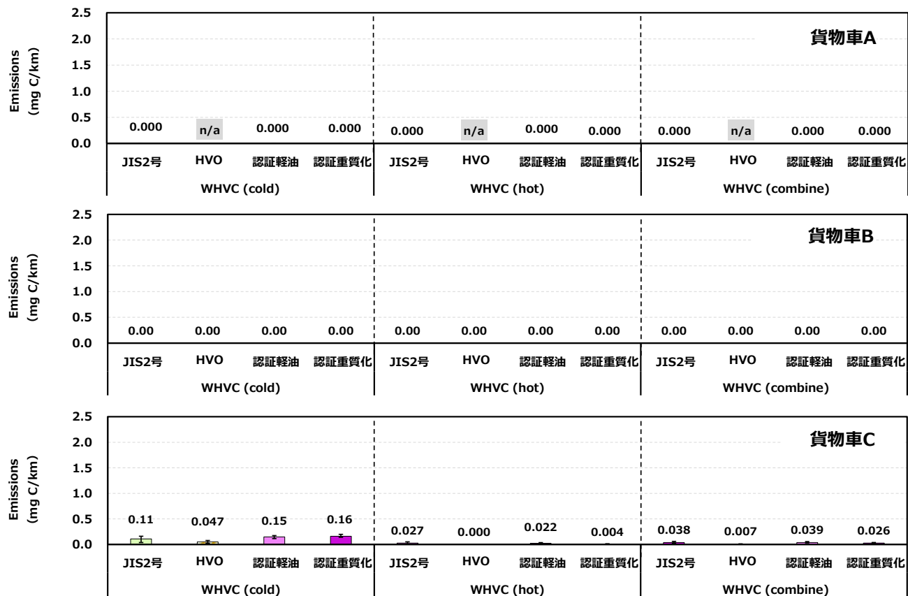
付録図 6-10 性状が異なる燃料による EC 排出量(mg C/km)の比較 (エラーバーは最大・最小を表す, n/a(not applicable)は「試験実施無し」)
