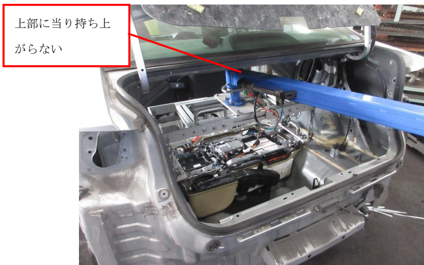
図 3.1.2-4 LIBユニットの取り出しが困難な状態
