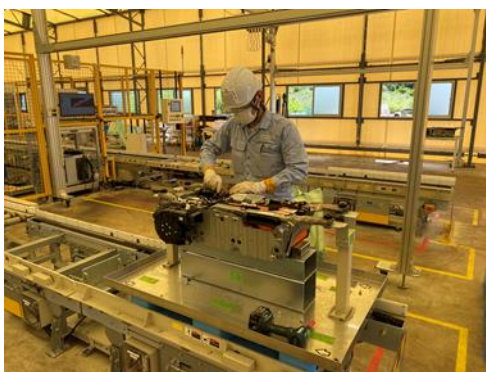
図 3.2.3-15 FIT3-LIB 手解体様子
