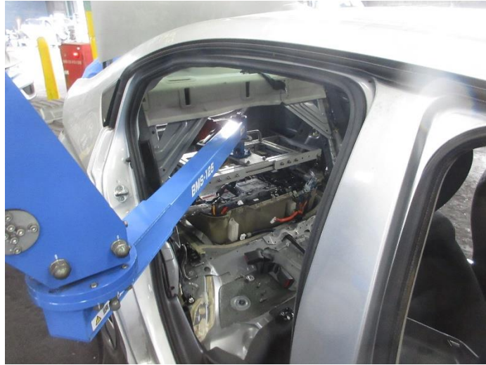
図 3. 1. 2-6 ホンダグレイスの後部乗降口から LIB ユニット取り出す様子
