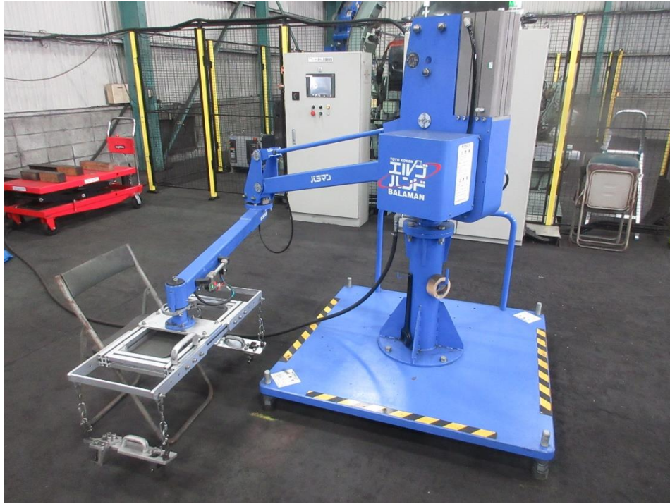
図 3. 1. 2-1 LIB ユニット取り出し助力装置全景
