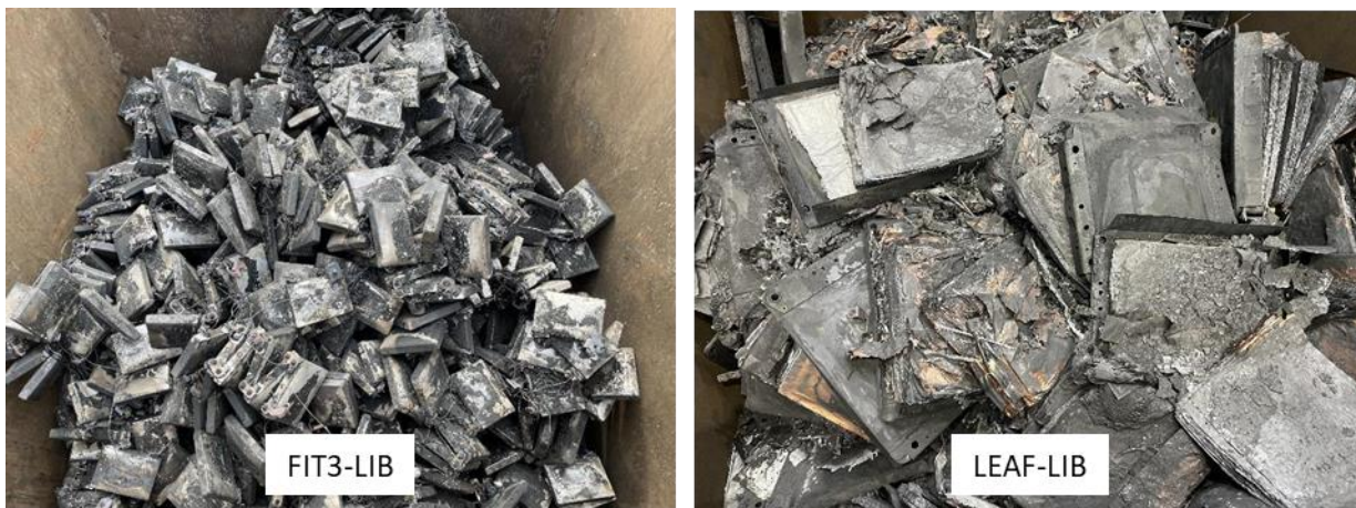
図 3.3.2-2 FIT3-LIB 及び LEAF-LIB モジュール熱分解物
