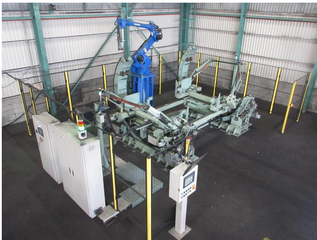
図 3. 1. 1-1 LIBユニット取り出し自動化装置全景画像
