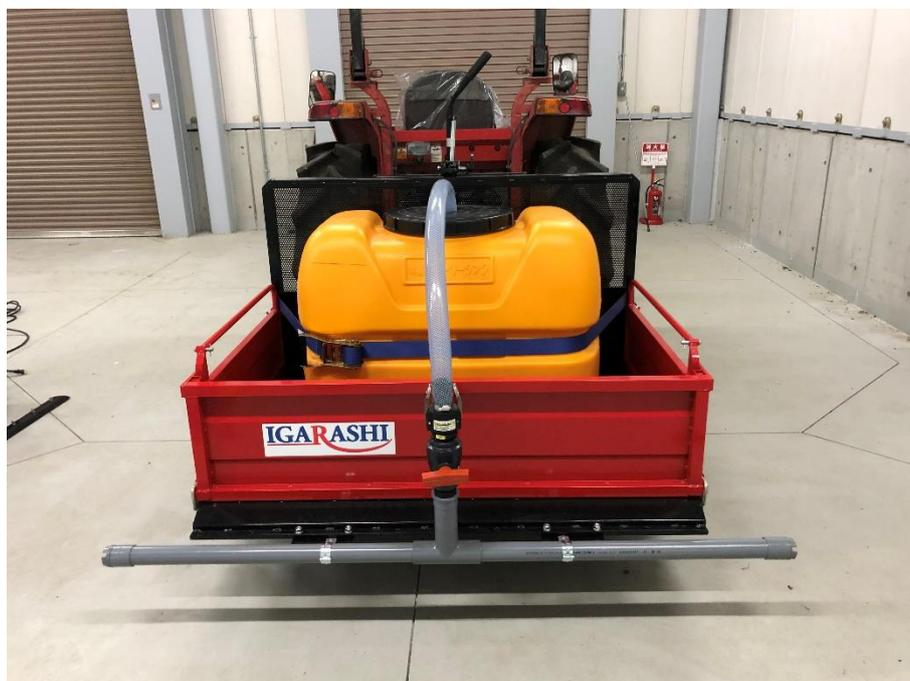
図12 トラクタでの散布装置
