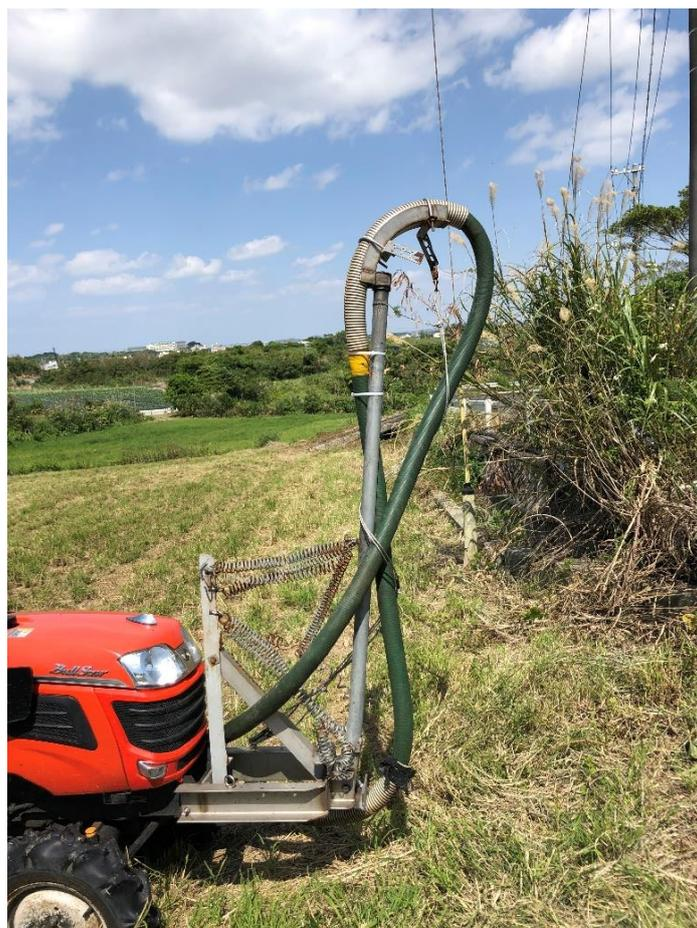
図14 トラクタへのホースの接続方法
