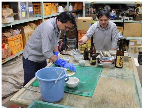
鍍金作業。まず、硝酸水銀を銅板に塗り、水銀を塗る前の下地を作る。
