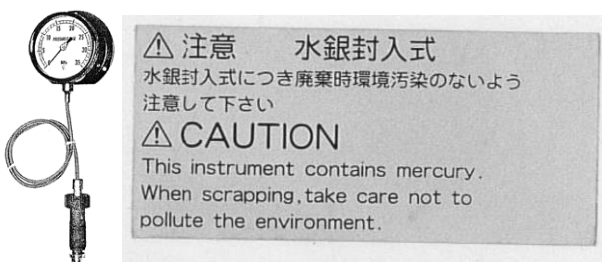
(写真) 高温用ダイヤフラムシール圧力計と注意銘板の例
