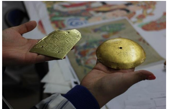
銅板金箔仕上げ作品例 (左が水銀箔鍍金、右は漆塗り表面に金箔を張る技法によるもの)
