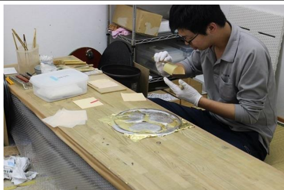
水銀を塗布した銅板に金箔を1枚ずつ貼り、はけで押し付ける。金箔は水銀とアマルガム化し、板上に定着する。5遍鍍金の場合は5層分、作業を繰り返す。
