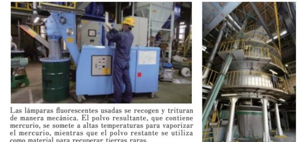
Las lámparas fluorescentes usadas se recogen y trituran de manera mecánica. El polvo resultante, que contiene mercurio, se somete a altas temperaturas para vaporizar el mercurio, mientras que el polvo restante se utiliza como material para recuperar tierras raras.
