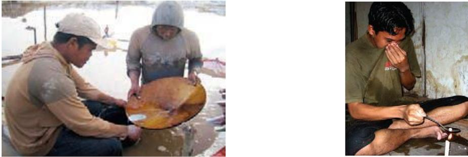
(左) 水銀を懸濁液と混ぜ、金アマルガムを生成、(右) 金アマルガムを加熱し、水銀を蒸発させ金を回収
