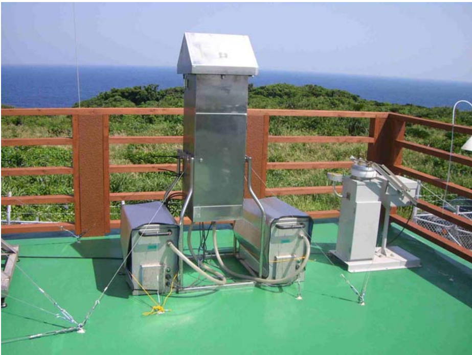
写真2 ローボリウムエアサンプラー (写真左)、降水サンプラー (写真右)
