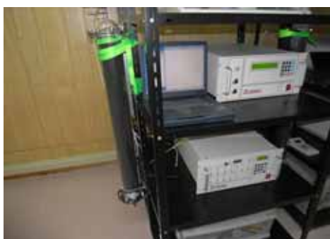
写真3 ブランクガス中の水銀低減（活性炭カラム装着）
