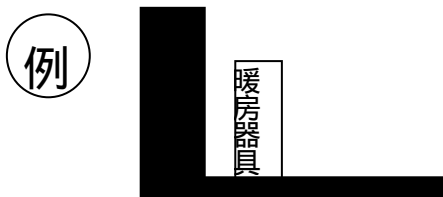
屋外への排気パイプがない。
