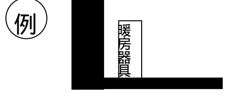
屋外への排気パイプがない。
