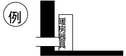
屋外への排気パイプがついている。
