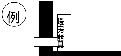
屋外への排気パイプがついている。
