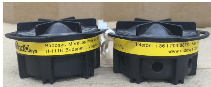
図 II-5 RADUET の外観。左が低換気率容器であり、右が高換気率容器である。 高換気率容器には 6 個の穴が開いている。
