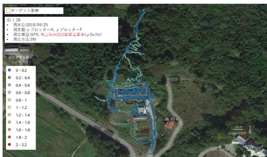
図 III-7 ガンマプロッターFにより測定された住家周辺及び屋内の空間線量率分布例。(地上5cm) 特に家屋内で連続モニタリング情報が得られていることがわかる。
