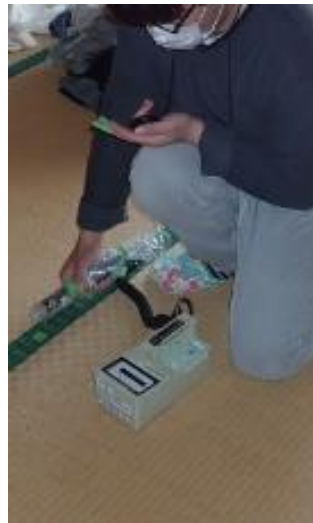
図 II-9 1”φx1”NaI シンチレーションサーベイメータ検出器を用いた 屋内外の空間線量率分布の測定の様子
