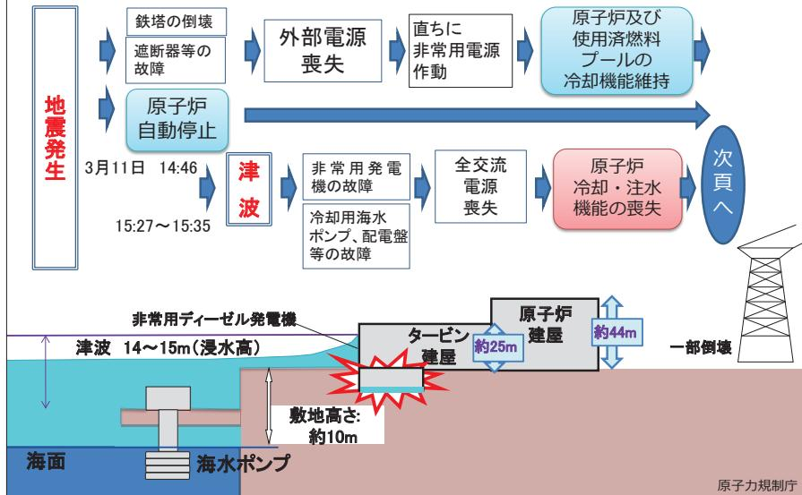
地震発生直後、運転中であった福島第一原子力発電所の1～3号機は全ての原子炉が自動停止しました。また、送電鉄塔の倒壊などにより外部電源が喪失したため、非常用ディーゼル発電機が自動起動しました。しかしながら、その後津波の襲来を受けて、起動した非常用ディーゼル発電機や配電盤などが被水・冠水し6号機を除き、すべての交流電源が喪失するとともに、冷却用の海水ポンプも機能を喪失しました。その結果、1号機では原子炉を冷却する機能が喪失しました。2号機及び3号機では、交流電源がなくても駆動できる冷却設備（2号機：原子炉隔離時冷却系（RCIC: Reactor Core Isolation Cooling System）、3号機：原子炉隔離時冷却系と高圧注水系（HPCI: High Pressure Coolant Injection System））でしばらく原子炉を冷却していましたが、やがてこれらも停止しました。
