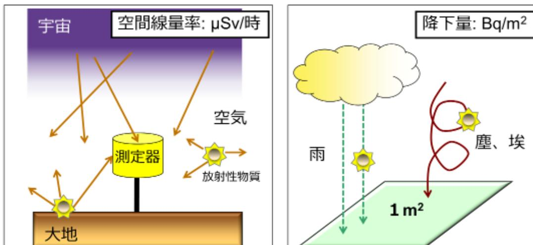
空間線量率というのは、空間中の $\gamma$ （ガンマ）線量を測定したもので、1時間当たりのマイクロシーベルトで表示されています。空気中に漂っている放射性物質からの $\gamma$ 線も検出していますし、大地に落ちた放射性物質からの $\gamma$ 線も検出しています。また計測しているのは事故由来の放射線だけではありません。自然放射線としては、主に大地からの放射線と宇宙線が挙げられます。
