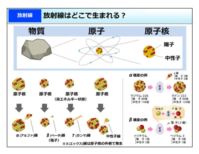
$\alpha$ (アルファ)線、 $\beta$ (ベータ)線、 $\gamma$ (ガンマ)線、X(エックス)線という名前は、これらの放射線が発見された当時、その実体が分からないために付けられた名称です。今では、 $\alpha$ 線とは、陽子2個と中性子2個からなるヘリウム原子核が高速で飛び出したものであることが分かっています。また $\beta$ 線は原子核から飛び出した電子です。ヘリウム原子核は、電子の約7,300倍の重さです。 $\alpha$ 線や $\beta$ 線を出した直後の原子核は、通常、まだエネルギーが高く、不安定な状態なので、 $\gamma$ 線を出して、より安定した状態になろうとします。しかし中には $\gamma$ 線を出さないものもあります。
