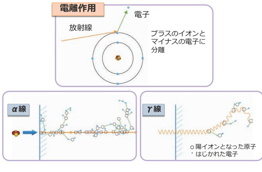
放射線が物質中を通過する場合、持っているエネルギーにより、物質を構成している原子が持つ軌道電子をはじき出して、陽電荷を帯びた状態の原子（又は陽イオンの分子）と自由な電子とに分離します。これを電離作用といいます。
