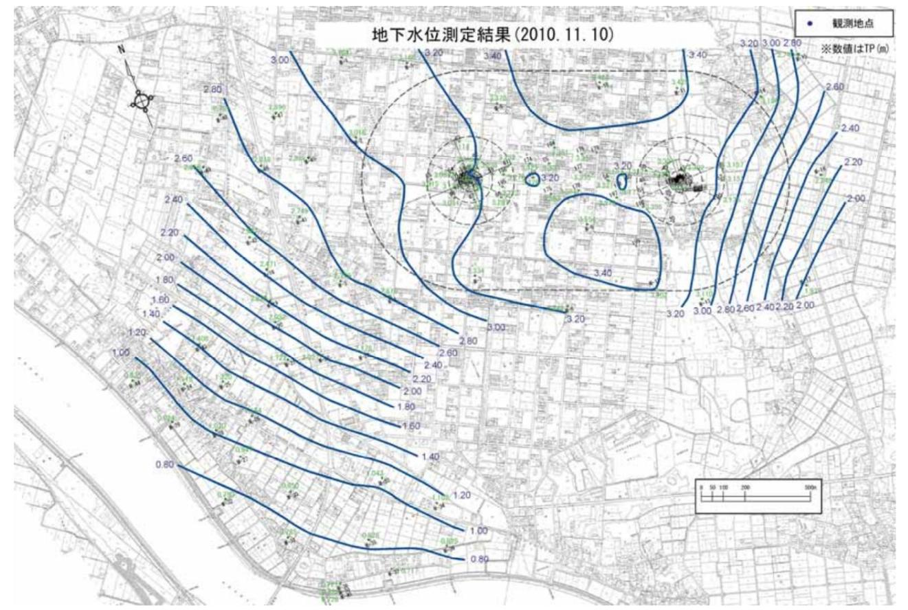
参考図2.1.20 地下水位測定結果 (2010.12.8、2011.1.13、2011.2.10、2011.3.9)
