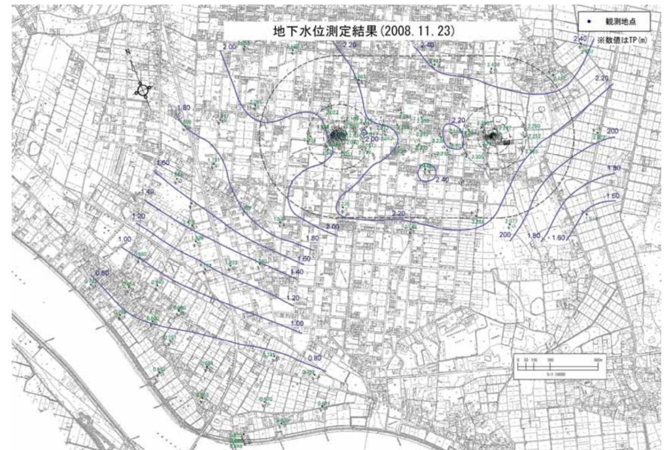
参考図2.1.14 地下水位測定結果 (2008.12.11、2009.1.20、2009.2.23、2009.3.18)
