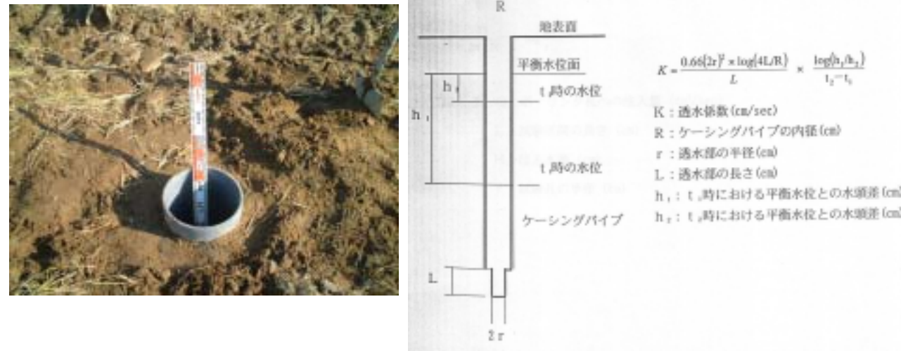
図 2.3.9 浸透試験透水係数算出方法
