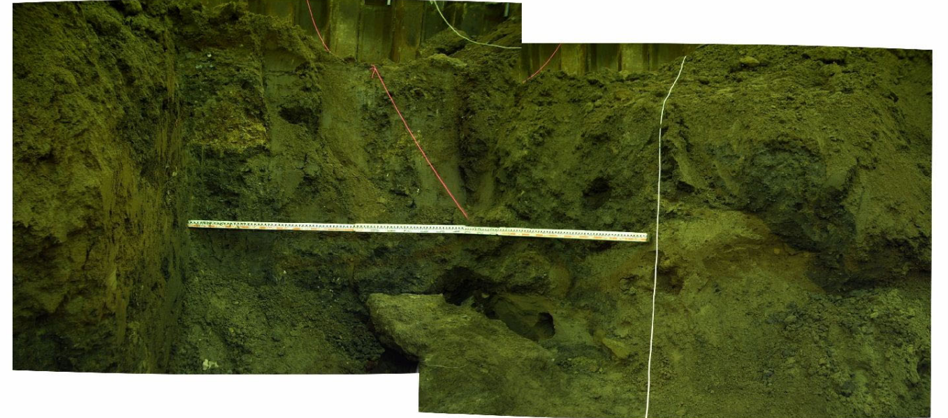
掘削断面②試料採取壁面写真(スタッフ位置がGL-2m)
