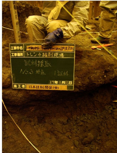
掘削断面③試料採取状況(左:採取位置写真 右:模式図)
