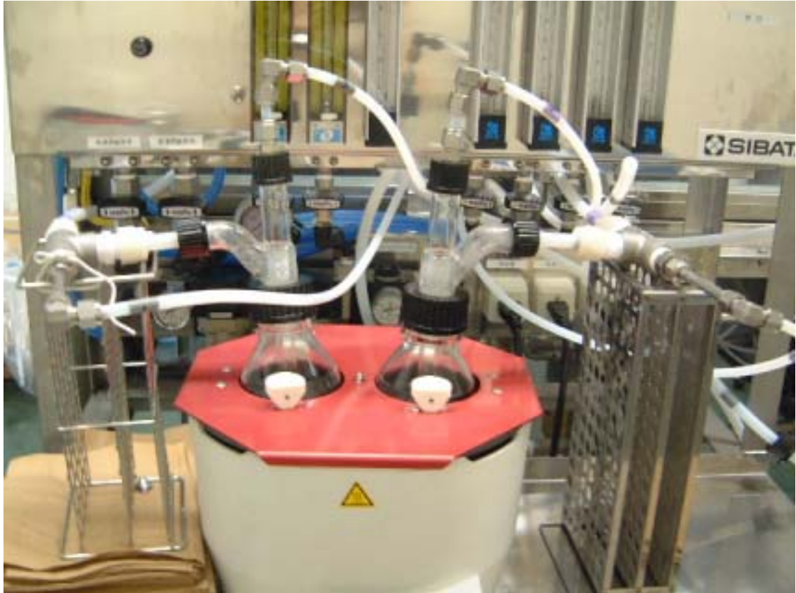
フタル酸エステルガス発生装置（改良型）
