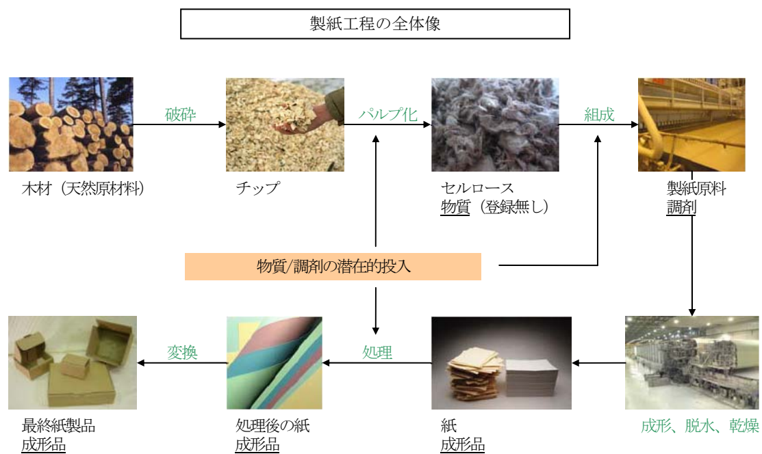
図 10 木材から紙成形品に至るまでの一般的な転換点の解説例
