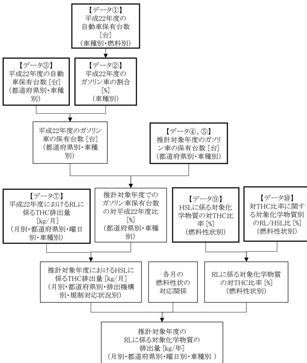
図 11-37 RL に係る THC 排出量の推計フロー
