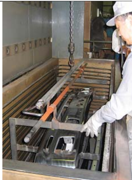
写真3 冷却ゾーンにおける液切りの様子
