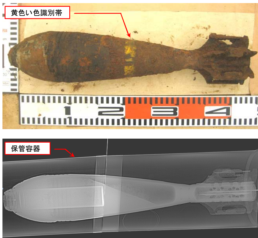
写真3 黄色い色識別帯が残る迫撃砲弾の事例とそのX線撮影写真 (砲弾は液面の有無を確認するために斜めに配置した状態で撮影した)
