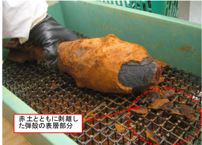
写真2 固着した赤土を除去した弾殻の状況 (弾殻には赤土が固着しており、これを除去する際に、弾殻の表層部分が赤土とともに剥落した。)
