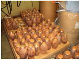
加熱燃焼炉に投入前の模擬化学弾 (90mm口径模擬弾) 火薬=TNT、模擬剤=ラウリン酸
