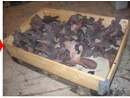
加熱燃焼炉で実処理後の模擬化学弾の状況
