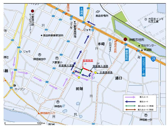
図一1 大型工事車両の通行ルートと交通誘導員の配置位置
