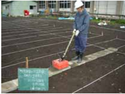
400MHz のアンテナを使用。 ブロック板を 1 段敷きにて実施 した際の実施状況。
