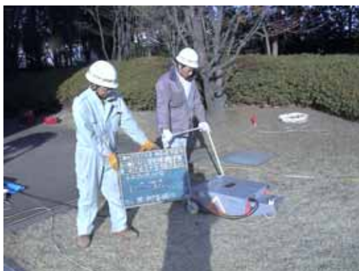
写真 レーダー探査(400MHz)
