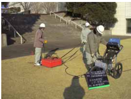
写真 レーダー探査(200MHz)
