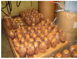
加熱燃焼炉に投入前の模擬化学弾 (90mm口径弾模擬弾) 火薬=TNT、模擬剤=ラウリン酸
