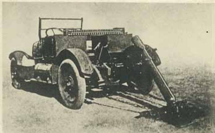
投射機搭載自動車より投射位置に移せる米軍四・二吋投射機
