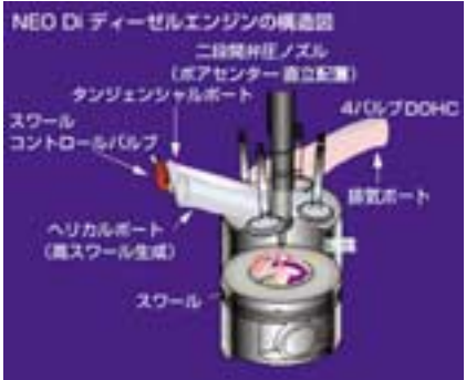
NEO Diディーゼルエンジンの燃焼室
