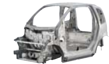
「ハイパーミニ」アルミスペースフレーム車体
